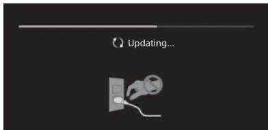
Не отсоединяйте кабель питания переменного тока во время обновления программного обеспечения. В противном случае обновление программного обеспечения может не завершиться, что может стать причиной некорректной работы программного обеспечения. Обновление программного обеспечения может занять до 15 минут.
