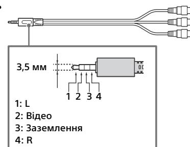
\*1 При підключенні монообладнання підключайте його до L(MONO) аудіороз'єму (гнізда).
